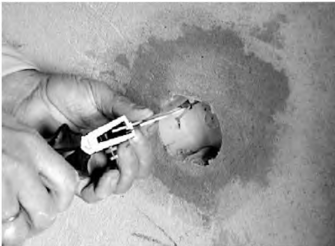
Рис. 3.6. Использование съемника изоляции
