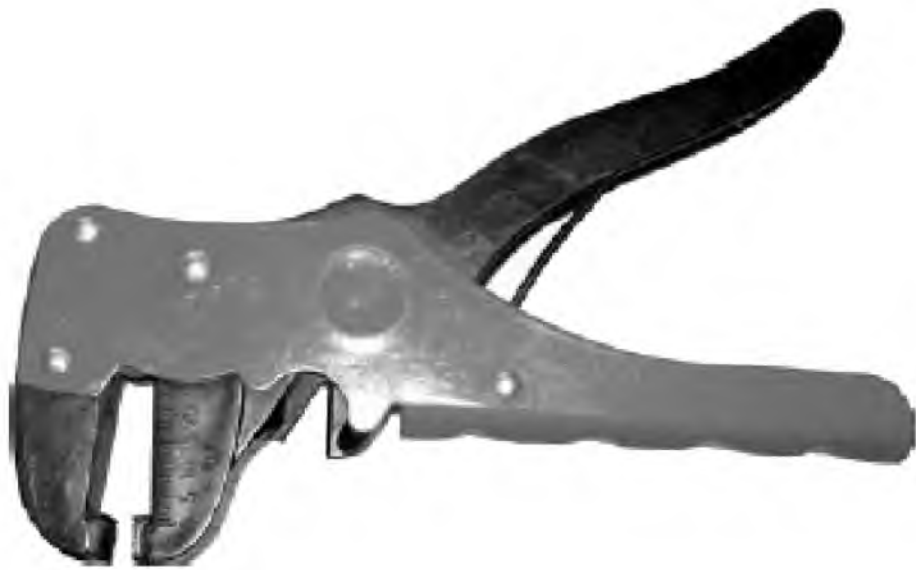
Рис. 5.3. Полуавтоматический съемник изоляции
