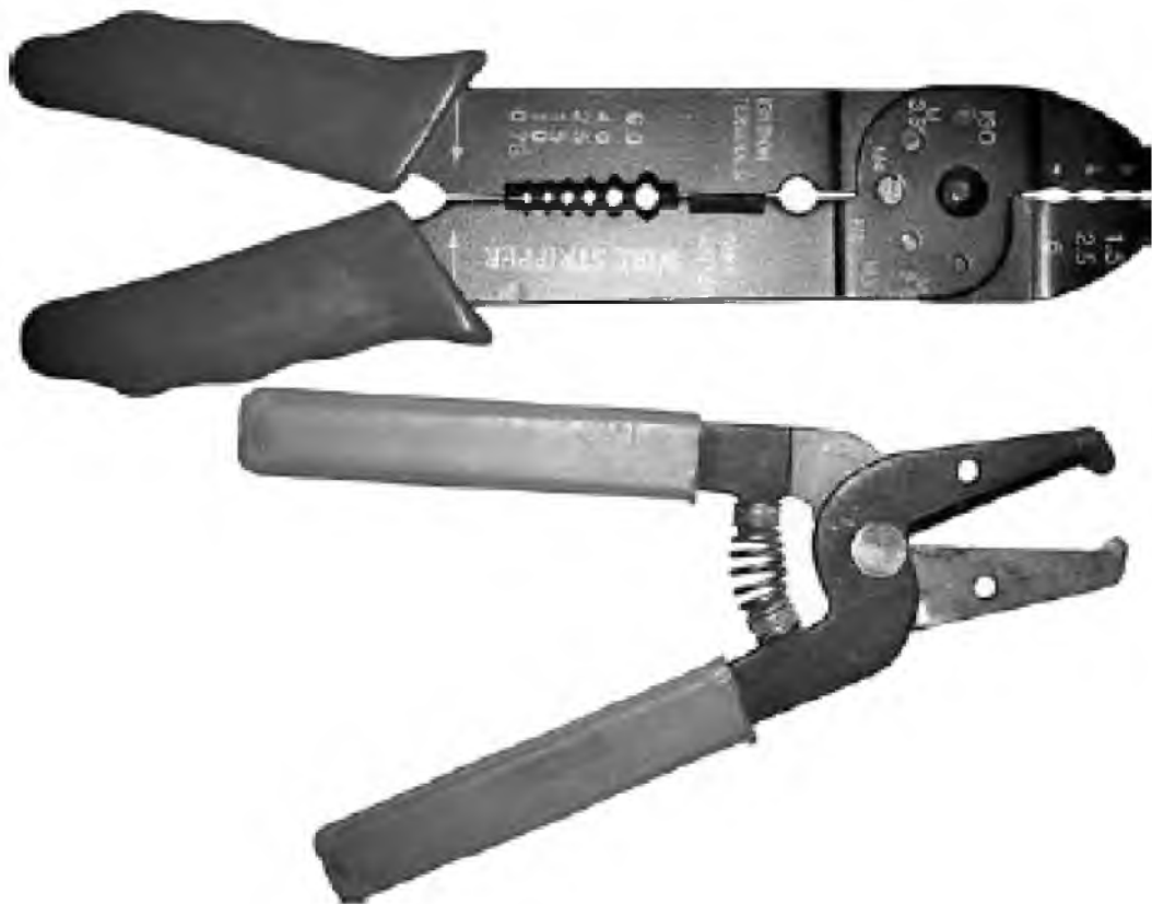
Рис. 5.2. Съемники изоляции
