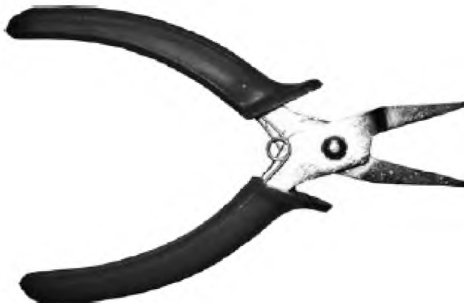
Рис. 5.5. Плоскогубцы для подгиба и скрутки проводов
