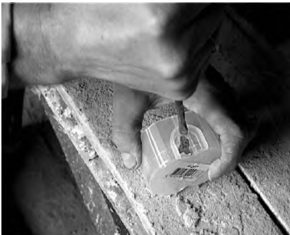
Рис. 1.6. Удаление технологической заглушки
