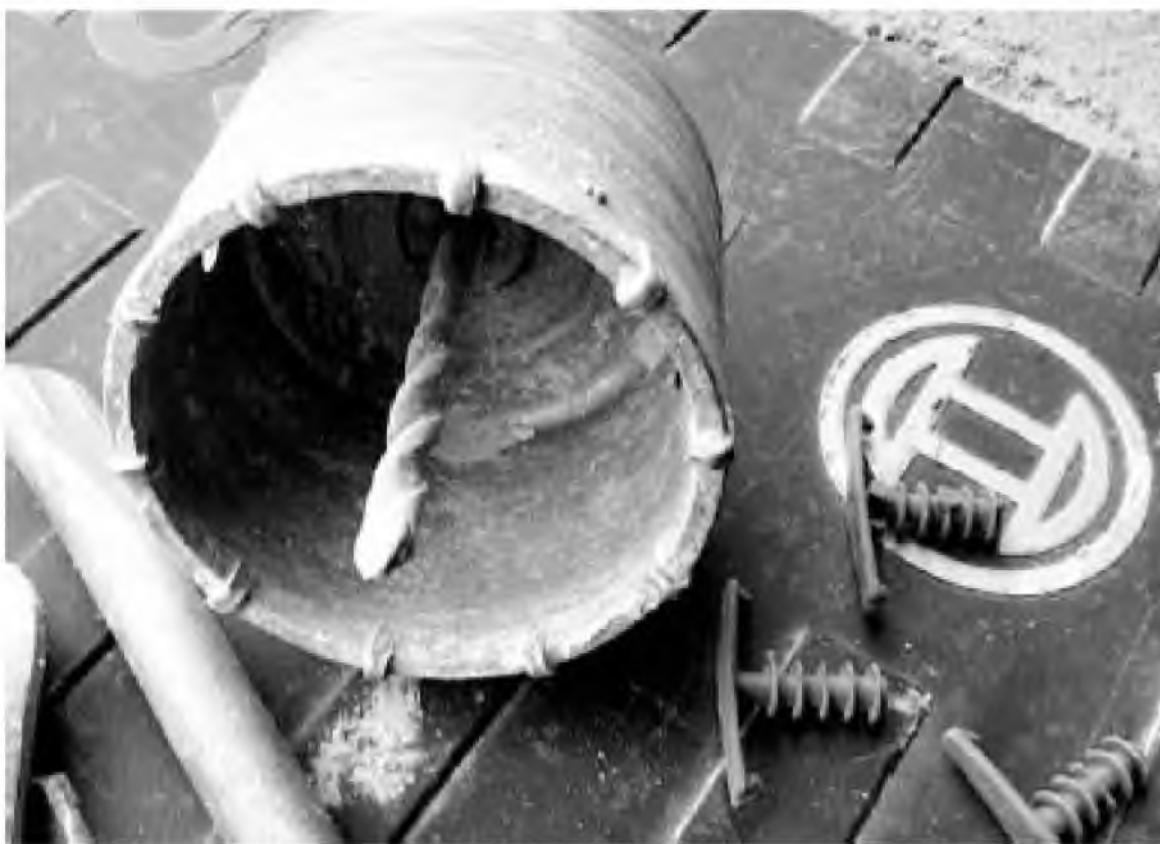
Рис. 5.17. Корончатая фреза
