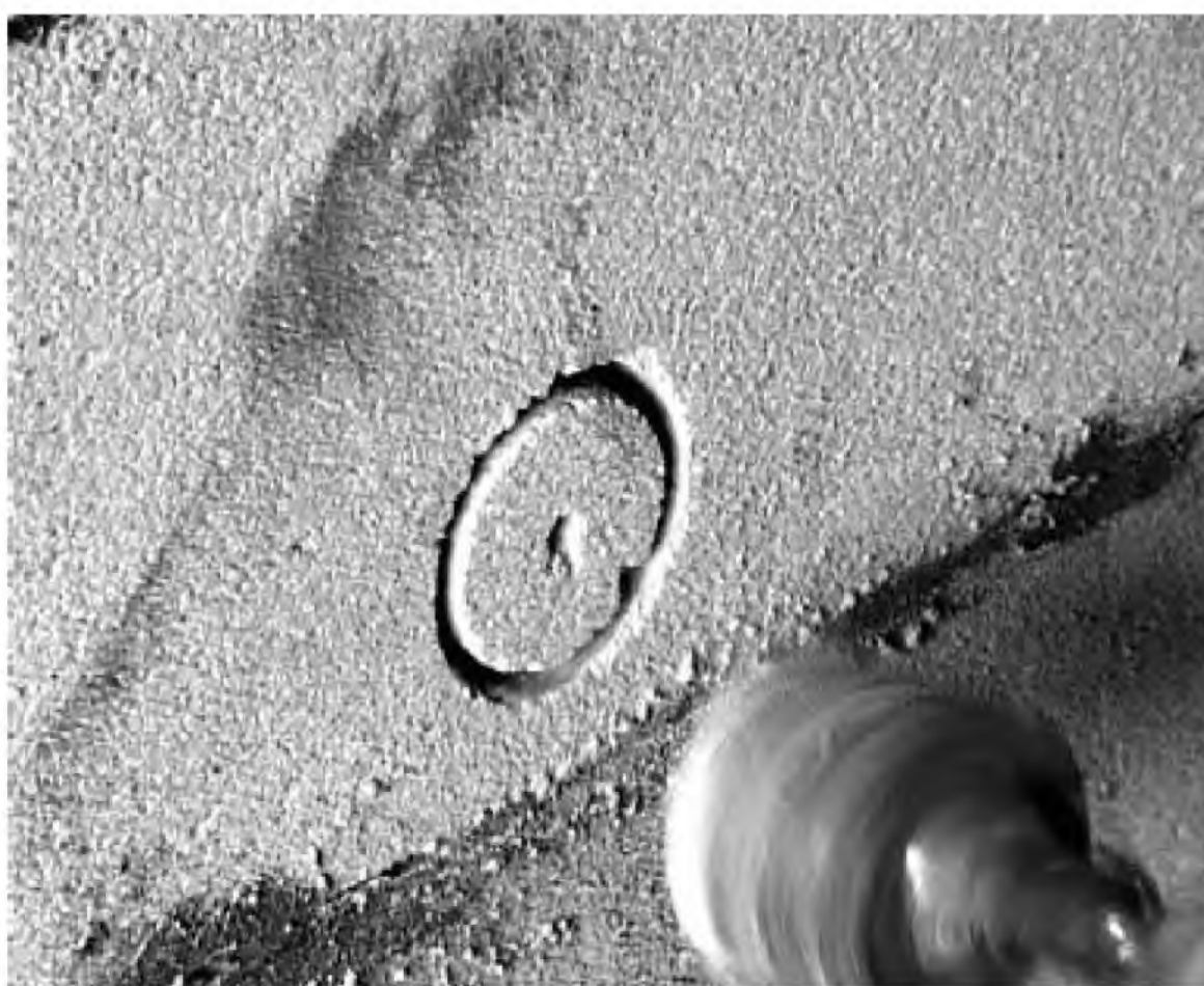
Рис. 5.19. Первый этап формирования круглого отверстия
