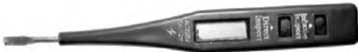
Рис. 5.25. Электронный фазный индикатор
