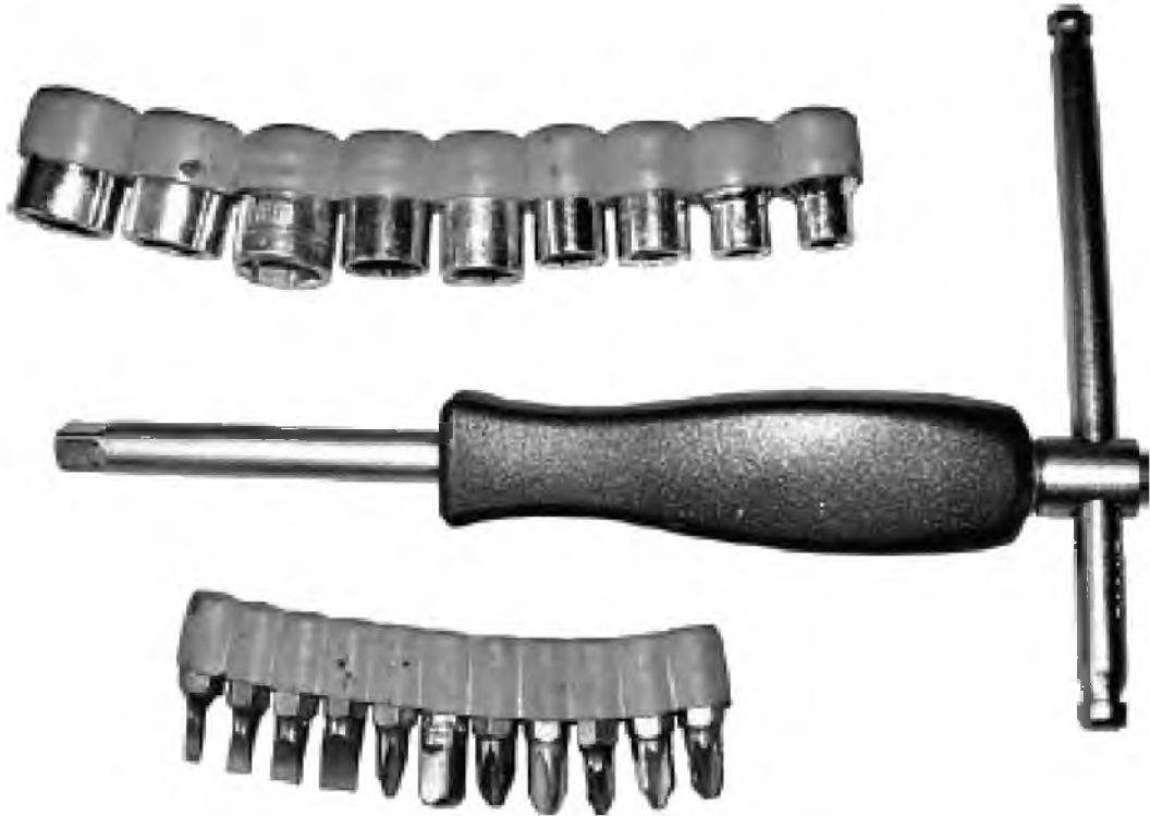
Рис. 5.9. «Биты» и универсальная рукоятка со съемным воротком
